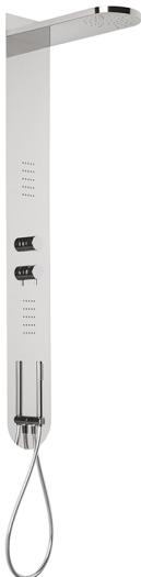
Pannello doccia monocomando 3 funzioni,pannello doccia in acciaio inox AISI 304,deviastop 3 uscite,supporto doccetta con presa d'acqua,doccetta monogetto D.23 mm in Ottone,2 soffiocini frontali,soffione rettangolare stondato L.500 Ø100 sp.24mm,funzione pioggia,flessibile PVC 150 cm
